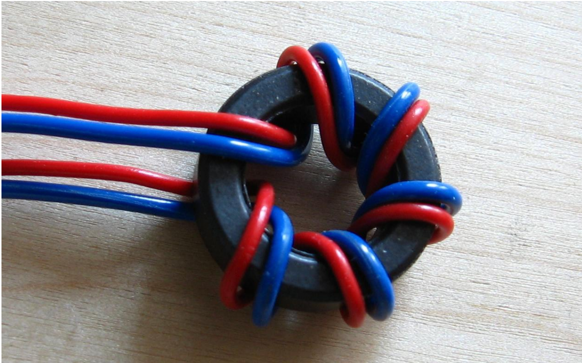
rys 25. Sposób nawijania dławików zakłóceń wspólnych. Nawijamy identycznie jak dławik L1 z tą różnicą, że jednocześnie obiema żyłami przewodów.
