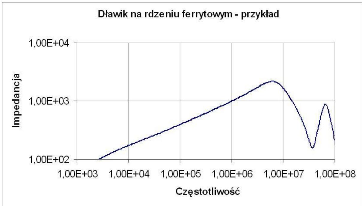
rys 8. Pomiar modułu impedancji dławika na rdzeniu ferrytowym
