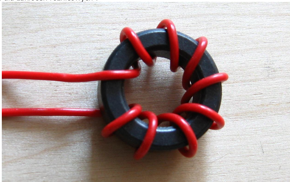
rys 23. Sposób nawijania L1. Zwoje luźno po obwodzie.
