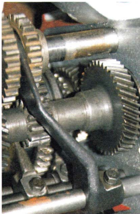
Rys. 3.139. Przykład zastosowania przekładni zębatych w skrzynce biegów
