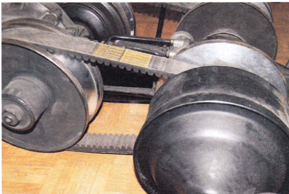
Rys. 3.145. Zastosowanie wariatora do przeniesienia napędu w samochodzie osobowym. Sterowanie przełożeniem odbywa się pneumatycznie. Rowki widoczne po wewnętrznej stronie paska ułatwiają dopasowanie go do średnicy koła pasowego
