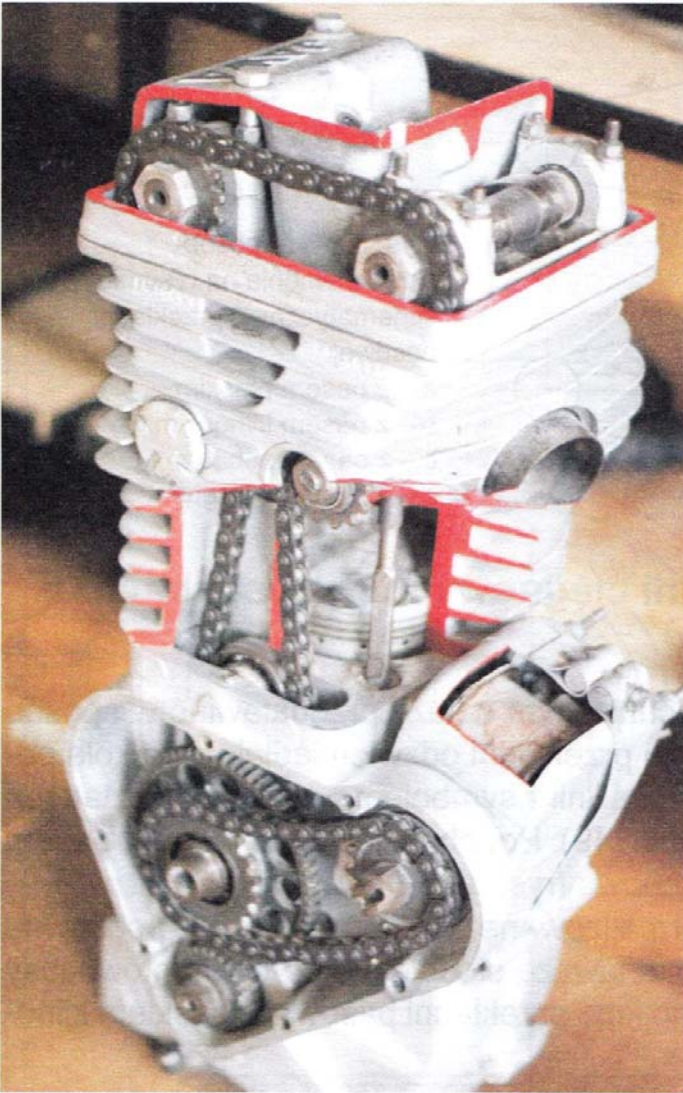
Rys. 3.147. Przykład zastosowania przekładni łańcuchowych w silniku motocykla żużlowego
